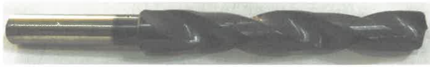
ภาพที่ 5 ดอกสว่านเหล็กน้ำพีหลังการเคลือบผิวไทเทเนียม (Coating TiAlN)
