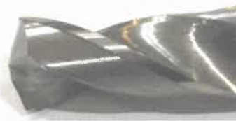
ภาพที่ 4 ดอกสว่านเหล็กน้ำพี้ที่ผ่านการขึ้นรูป
