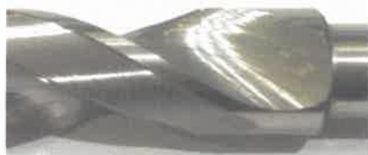
ภาพที่ 4 ดอกสว่านเหล็กน้ำพี้ที่ผ่านการขึ้นรูป
