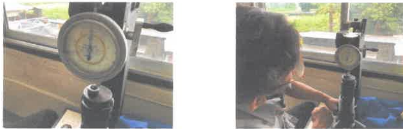
ภาพที่ 8 การทดสอบความแข็งแบบ Rockwell (HRC)
