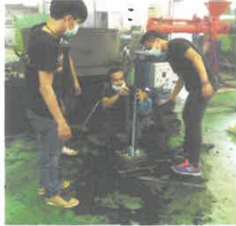
ภาพที่ 2 การเตรียมแบบหล่อเหล็กน้ำพี้และการเทเหล็กน้ำพี้ที่พัฒนาคุณสมบัติ
