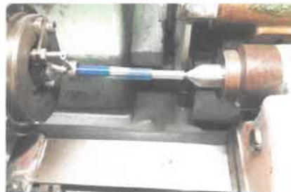
ภาพที่ 3 การขึ้นรูปเครื่องมือตัดดอกสว่านเหล็กน้ำพี้
