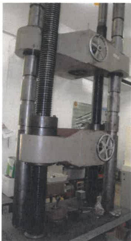
ภาพที่ 8 เก็บข้อมูลกำลังรับแรงดึงของเหล็กเสริมโดยการทดสอบ Tensile test
