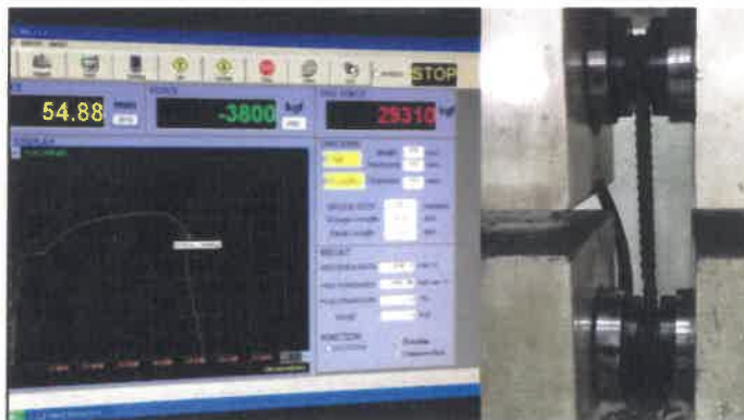
ภาพที่ 8 เก็บข้อมูลกำลังรับแรงดึงของเหล็กเสริมโดยการทดสอบ Tensile test
